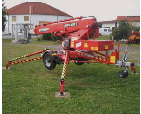
Bild 3-1: Teleskopmastbühne Typ 1B
