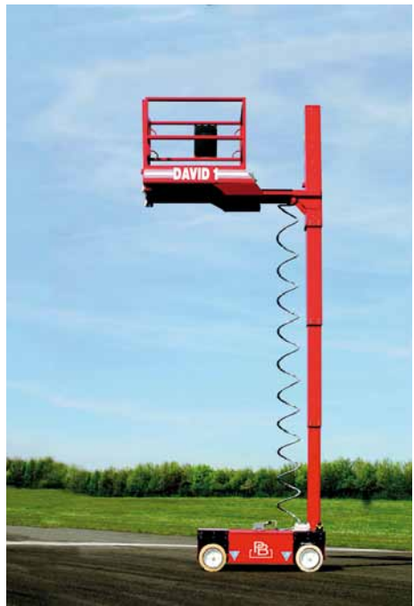
Bild 3-2: Stempelmastbühne Typ 3A
