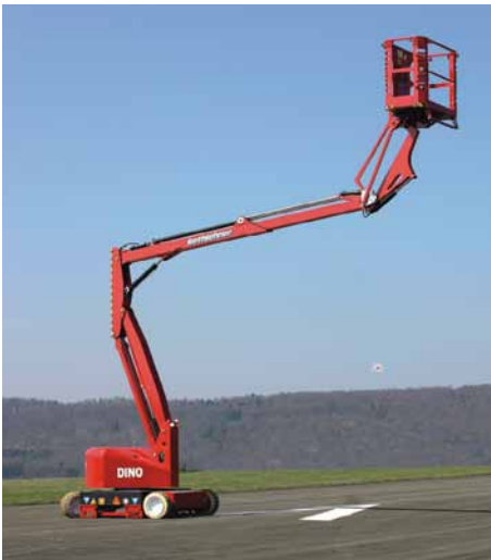
Bild 3-4: Gelenkteleskopbühne Typ 3B
