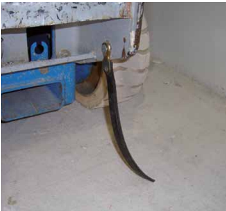
Bild 4-9: Antistatikband zur Ableitung elektrostatischer Aufladungen der Hubarbeitsbühne
