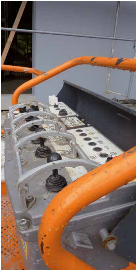
Bild 6-3: Schutzbügel gegen unbeabsichtigtes Betätigen der Bedienelemente
