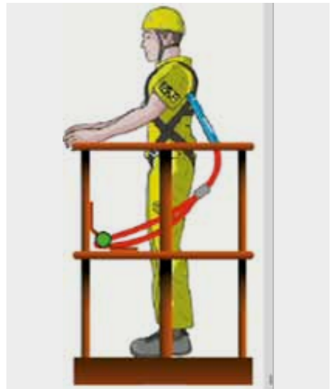
Bild 9-3: Einsatz von PSA gegen Absturz beim Verfahren
