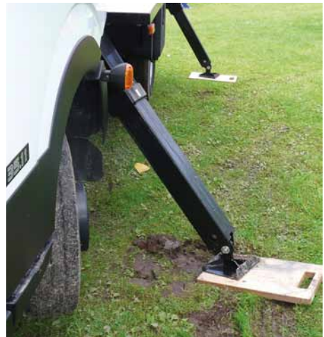
Bild 4-4: Gute (hinten) und schlechte (vorne) Abstützung
